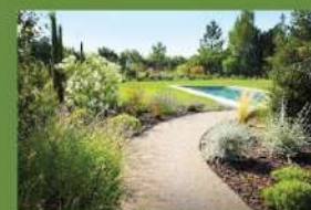
Allée compacte stabilisé pour accès PMR avec bordure en bois, largeur 2,80m
