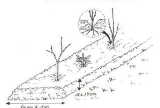
Les copeaux sont déposés après la plantation, sur 12 à 15 cm d'épaisseur minimum, sur 80 cm à 1 m de large. Dégager la base du plant afin de laisser à l'air libre le collet. 8 à 10 m3 sont nécessaires pour pailler 100 mètres linéaires de haie équivalant à 100 plants.
